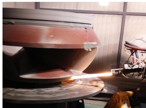
图 2 HVOF 超音速火焰喷涂制备 CoCrWC 涂层
